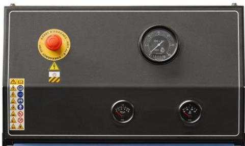
**Пульт М80** имеет двойное назначение. Он служит обычной контактной платой для соединения электрошкафа и щитка приборов, чьи инструменты позволяют отслеживать основные параметры электроагрегата.
