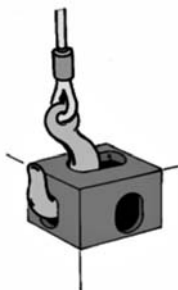
Пример захвата обычным крюком
