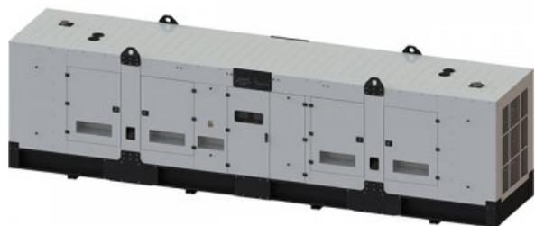
FOGO TWIN состоит из двух полностью независимых генераторов с независимым управлением топливом, вентиляцией, выхлопом и электрическими системами. Он позволяет работать с одним генератором только в том случае, если это необходимо. В то же время альтернативный вариант работы уменьшает износ каждого двигателя в случае меньшей потребляемой мощности.
