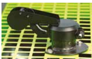
Дождевая крышка на выхлопной трубе
