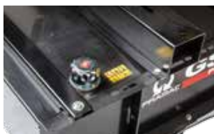
Металлический топливный бак, интегрированный в раму
