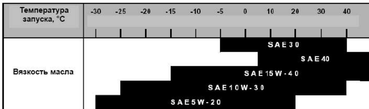
Рис. 6.1. Рекомендуемая вязкость моторного масла.
